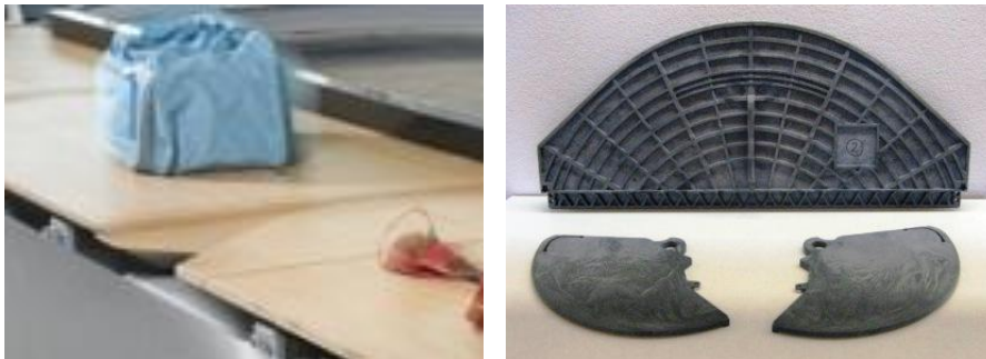
Tragkomponenten eines Gepäckhandlingsystems mit Hilfe von TSG hergestellt
